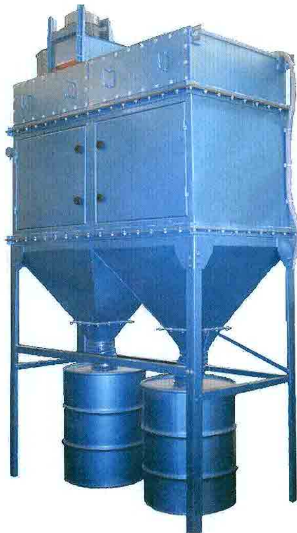
Colector de polvo modelo VC-8 con ventilador y compuerta reguladora a la descarga; integrado en la parte superior del gabinete, tolvas de almacenamiento de polvo y tambos de 200 litros
